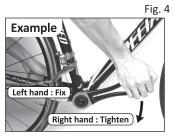
Tightening torque 30~50N.m (300~500kgf.cm)
